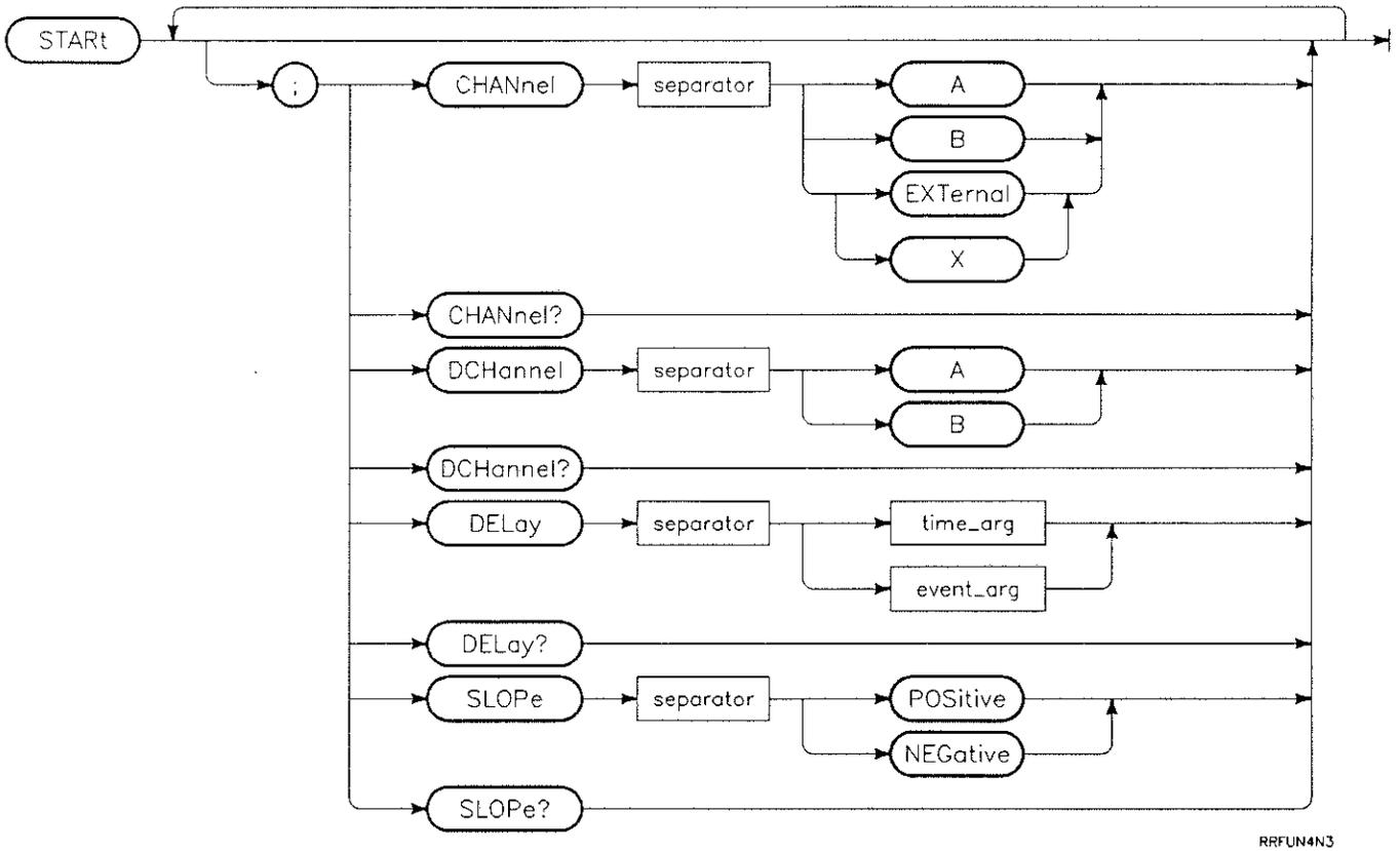
Figure 5-10. MEASUREMENT Subsystem START Sublevel Syntax Diagram
