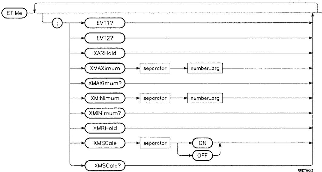
Figure 5-5. GRAPHic Subsystem, ETIME Sublevel Syntax Diagram
