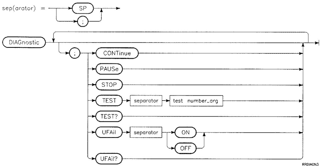
Figure 5-17. DIAGnostic (TEST) Subsystem Syntax Diagrams
