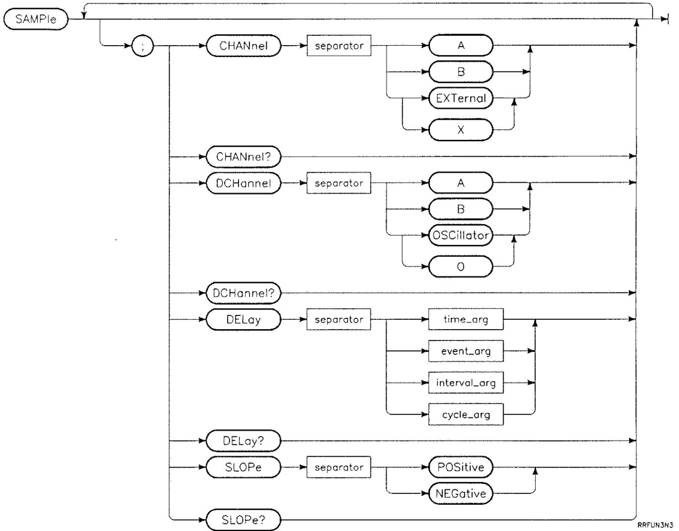
Figure 5-9. MEASUREMENT Subsystem SAMPLE Sublevel Syntax Diagram
